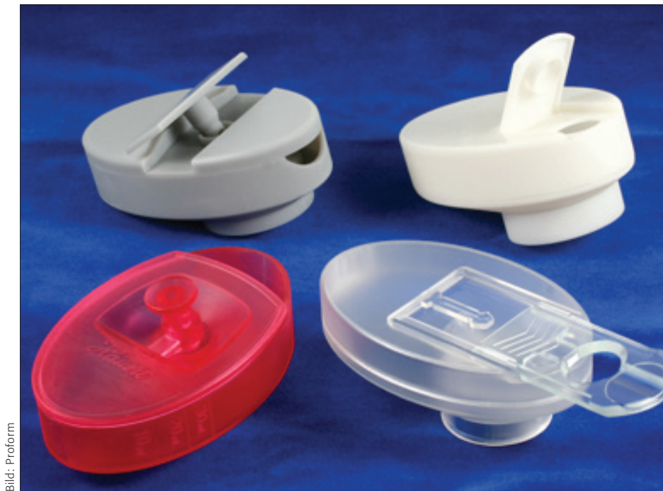
Stereolithographiemodelle diverser Entwicklungsstufen des Düngerdosierdeckels.
